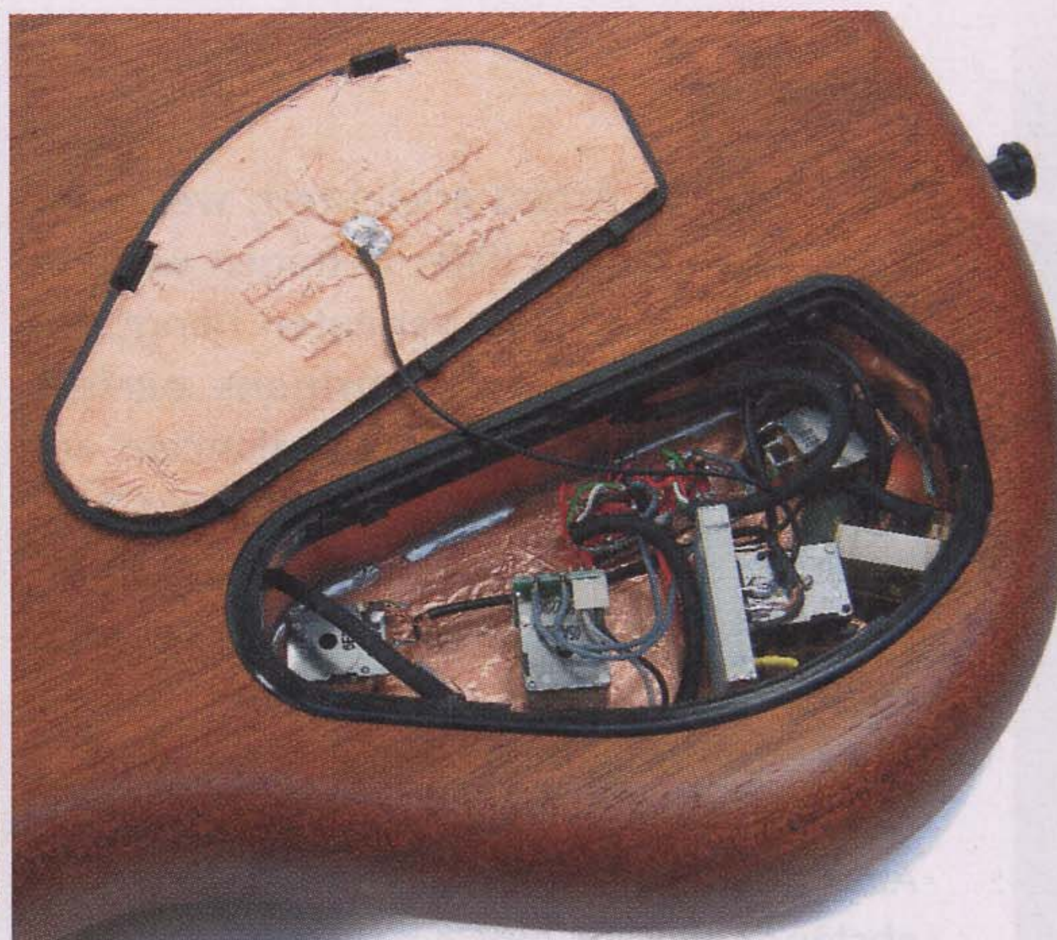
Aufgeräumte Ordnung im rundum abgeschirmten Elektronikfach
